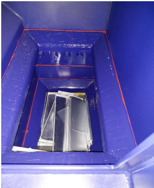
Abbildung 2 - LIB-Pouch-Zellen im Einlauftrichter zum Vorzerkleinerer
