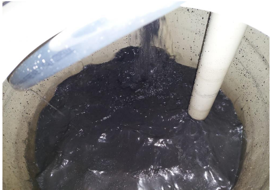
Abbildung 3 - Das zerkleinerte Material wird einer Friktionswäsche unterzogen, um die Kathodenmaterialien von den Metallelektroden zu lösen
