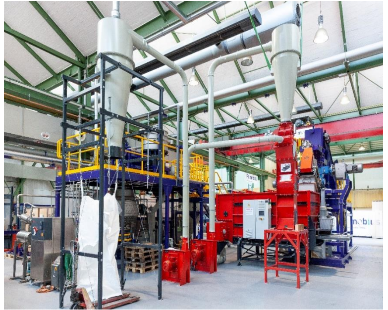
Abbildung 1 - Profil des Zerkleinerungs- und Aufbereitungskreislaufs von Primobius
